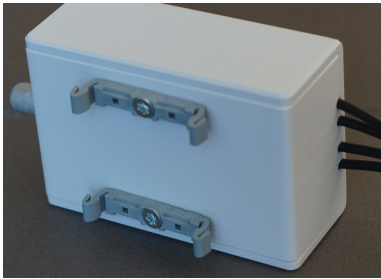
Vue arrière du BPL-DUAL : griffes de montage sur rail DIN
